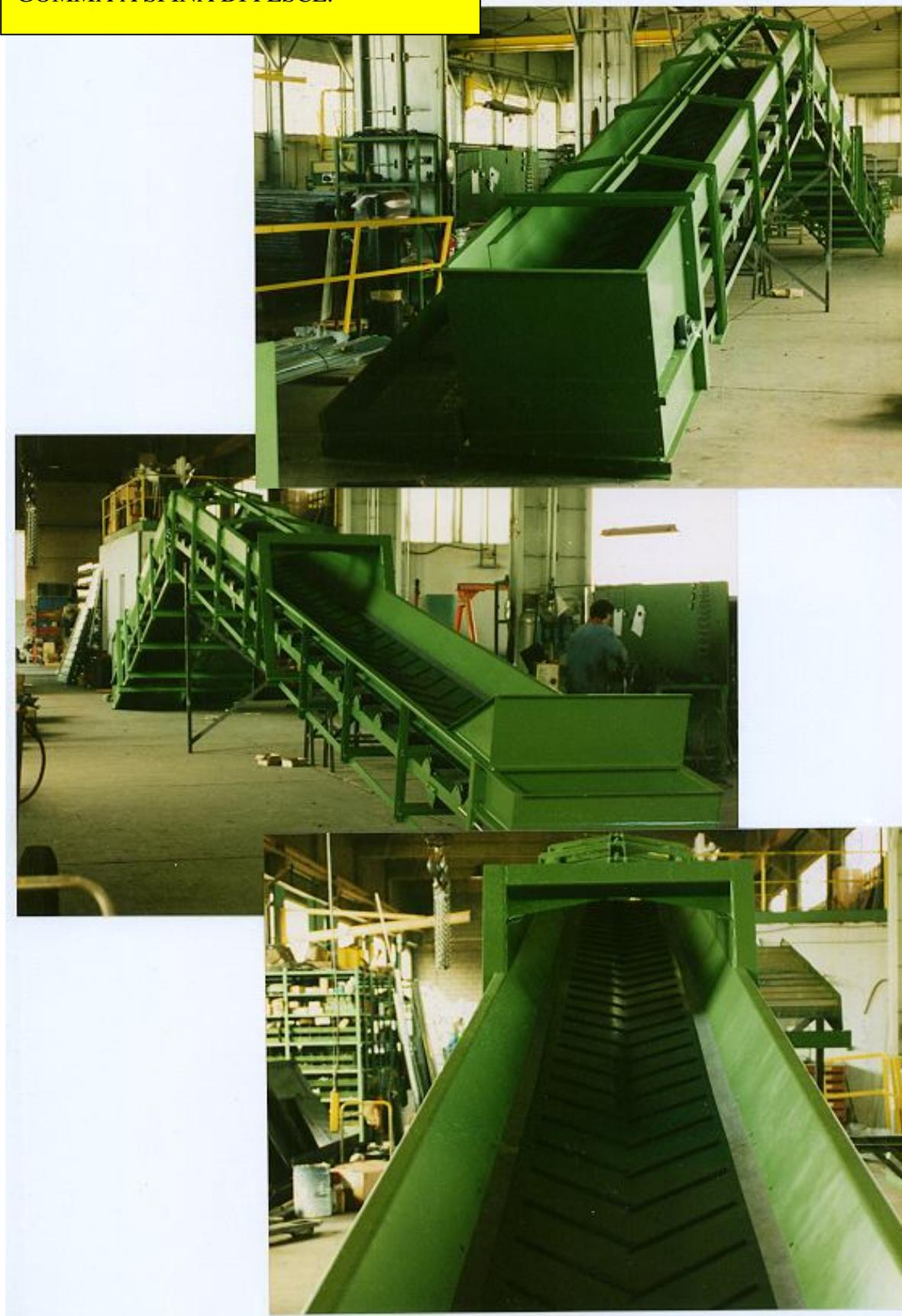
TRASPORTATORE A NASTRO IN GOMMA CON SPONDE LATERALI DI CONTENIMENTO.
